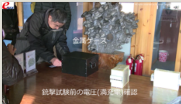
銃撃試験前の電圧(満充電)確認 金属ケース
