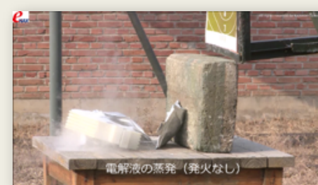
電解液の蒸発(発火なし)
